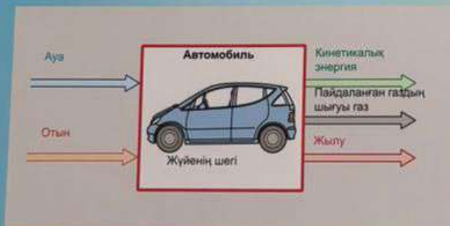
2-сурет. Автомобиль мысалындағы жүйенің жалпы сызбасы
