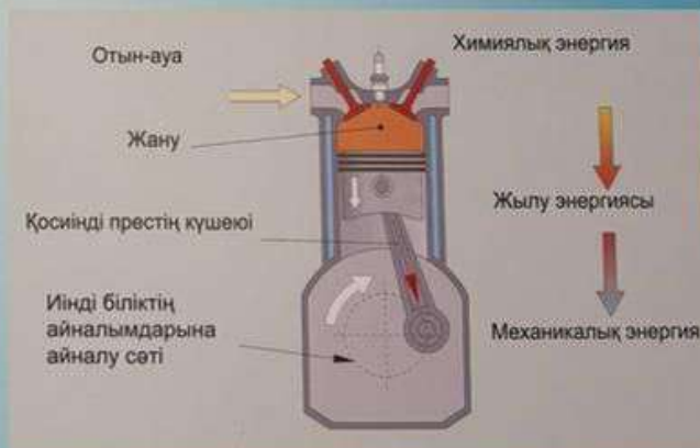
2-сурет. Ұшқынды оталдырумен іштен жанатын қозғалтқыш энергиясының түрленуі
